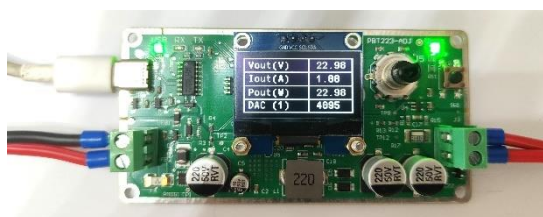
Figure 15 PBT223-ADJ DAC 模式 = 4095
