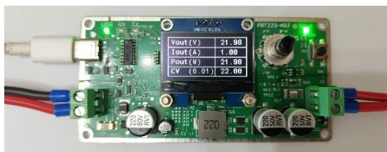
Figure 11 PBT223-ADJ CV 模式 = 22V
