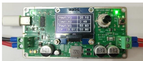
Figure 13 PBT223-ADJ CP 模式 = 50W
