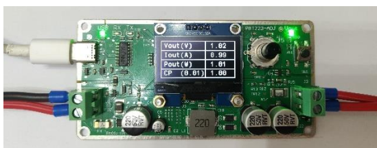
Figure 12 PBT223-ADJ CP 模式 = 1W
